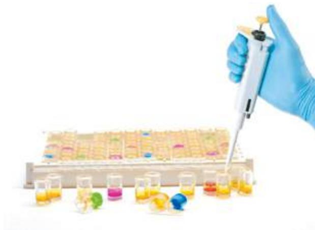
Наборы МикроЛаТест® — микротитровальные 96-луночные пластинки с 1, 2 или трехрядными вертикальными полосками для постановки 8, 16 или 24 биохимических реакций. Лунки полосок содержат дегидратированные субстраты. При добавлении суспензий микроорганизмов субстраты растворяются, в ходе инкубации происходят биохимические реакции, результаты которых можно зарегистрировать по изменению цвета индикатора визуально, либо автоматически при наличии фотометров (ErbaScan, Multiscan FC).
