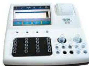
ECL 412 – 4-х канальный полуавтоматический коагулометр, позволяющий проводить весь спектр исследований крови на гемостаз. Идеален для лабораторий с небольшими и средними рабочими потоками.
