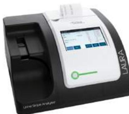
Анализатор LAURA® с диагностическими тест-полосками ФАН® ЛАУРА—эффективная система для объективного высококачественного измерения различных параметров мочи. Система полуавтоматического полуколичественного анализа позволяет объективно, точно и быстро проводить ежедневные рутинные измерения в клинической лаборатории. Жидкокристаллический экран с сенсорным управлением обеспечивает удобство контроля работы анализаторов. Приборы автоматически распознают типы используемых тест-полосок.
