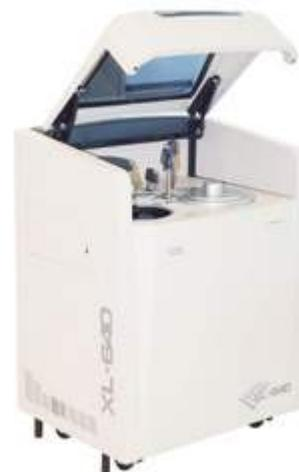
Автоматический биохимический анализатор с много-разовыми реакционными кюветами, промываемыми на борту прибора; предназначен для проведения полного спектра биохимических, иммунотурбидиметрических исследований в лабораториях со средними рабочими потоками. Может комплектоваться встроенным ионоселективным блоком (ISE).
