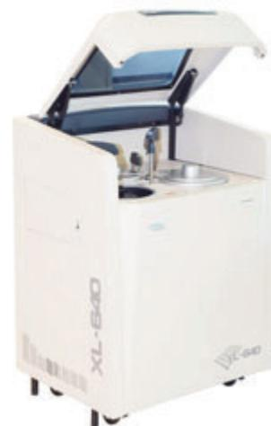
Автоматический биохимический анализатор с многоразовыми реакционными кюветами, промываемыми на борту прибора; предназначен для проведения полного спектра биохимических, иммуннотурбидиметрических исследований в лабораториях со средними рабочими потоками. Может комплектоваться встроенным ионоселективным блоком (ISE).
