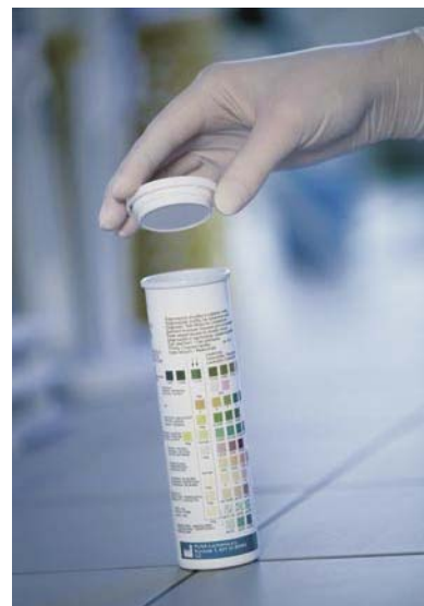
3. Тубу плотно закрывают. Осушитель предохраняет от действия влажности воздуха.
